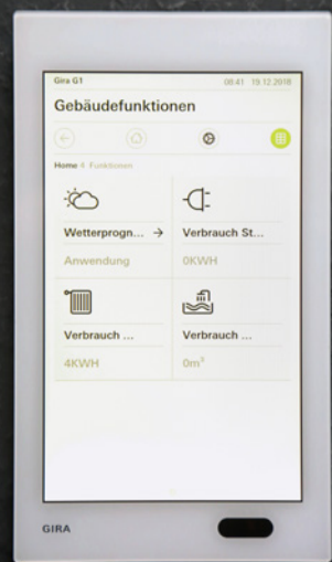
Nutzerinformation: Über solche Displays wird der Energieverbrauch in den Wohnungen laufend angezeigt.
