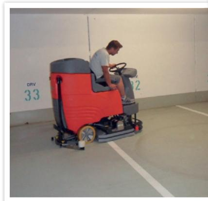
Die maschinelle Nassreinigung entfernt Streusalzrückstände vollständig und mindert die Unfallgefahr durch Ölrückstände.
