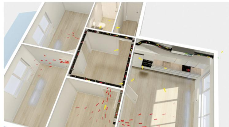
Die Grafik zeigt den möglichen Aufbau einer Nachrüstung im Bestand. Über der Küche wird Frischluft (grün) angesaugt, im Lüftungsgerät gefiltert und bei Geräten mit Wärmerückgewinnung über die Abluft temperiert. Anschließend wird die aufbereitete Luft (rot) mit einem Kanalsystem in die Räume befördert. Die Abluft (gelb) wird abgesaugt und nach draußen befördert.
